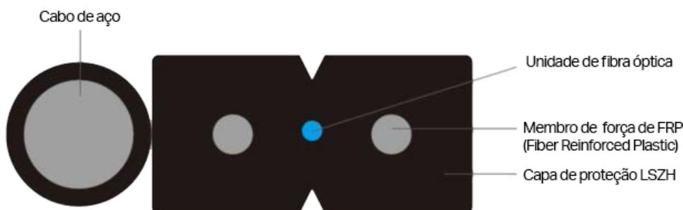
A fibra especial de baixa sensibilidade à curvatura proporciona alta largura de banda e excelente propriedade de transmissão de comunicação. Dois elementos de força de FRP (Fiber Reinforced Plastic) paralelo asseguram um bom desempenho da resistência a esmagamento para proteger a fibra. O fio de aço simples como elemento de força adicional assegura um bom desempenho da resistência à tração.
