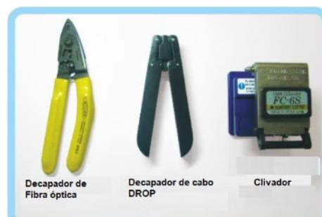
Ferramentas de montagem do conector
