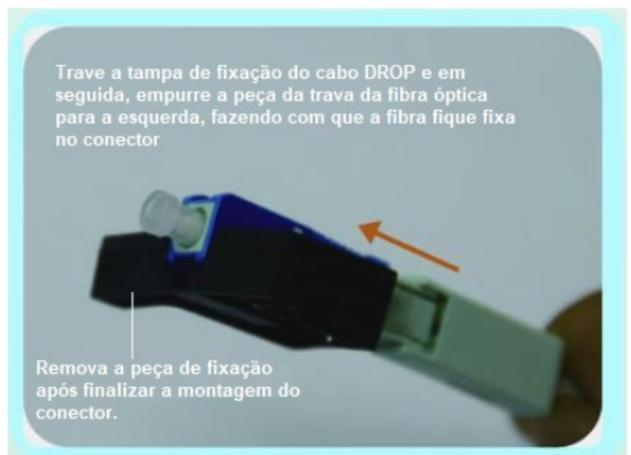
Trave a fibra no conector, empurrando a peça da trava para a esquerda.
