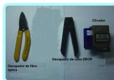
Ferramentas de montagem do conector
