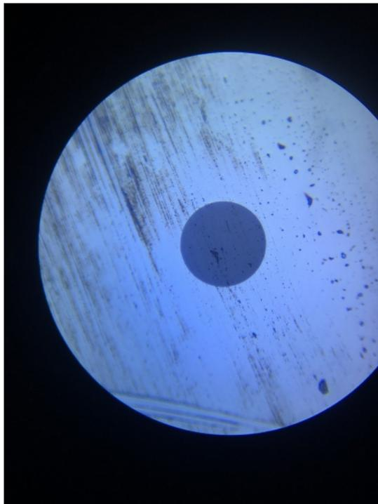
Como pudemos ver na imagem acima, o ferrolho está totalmente sujo. Deve-se realizar a limpeza do conector com a ajuda da Caneta para Limpeza de Conectores Ópticos OT-8451-CL/OT-8452-CL, ou do Limpador de Conector de Fibra Óptica OT-8437-LP:
