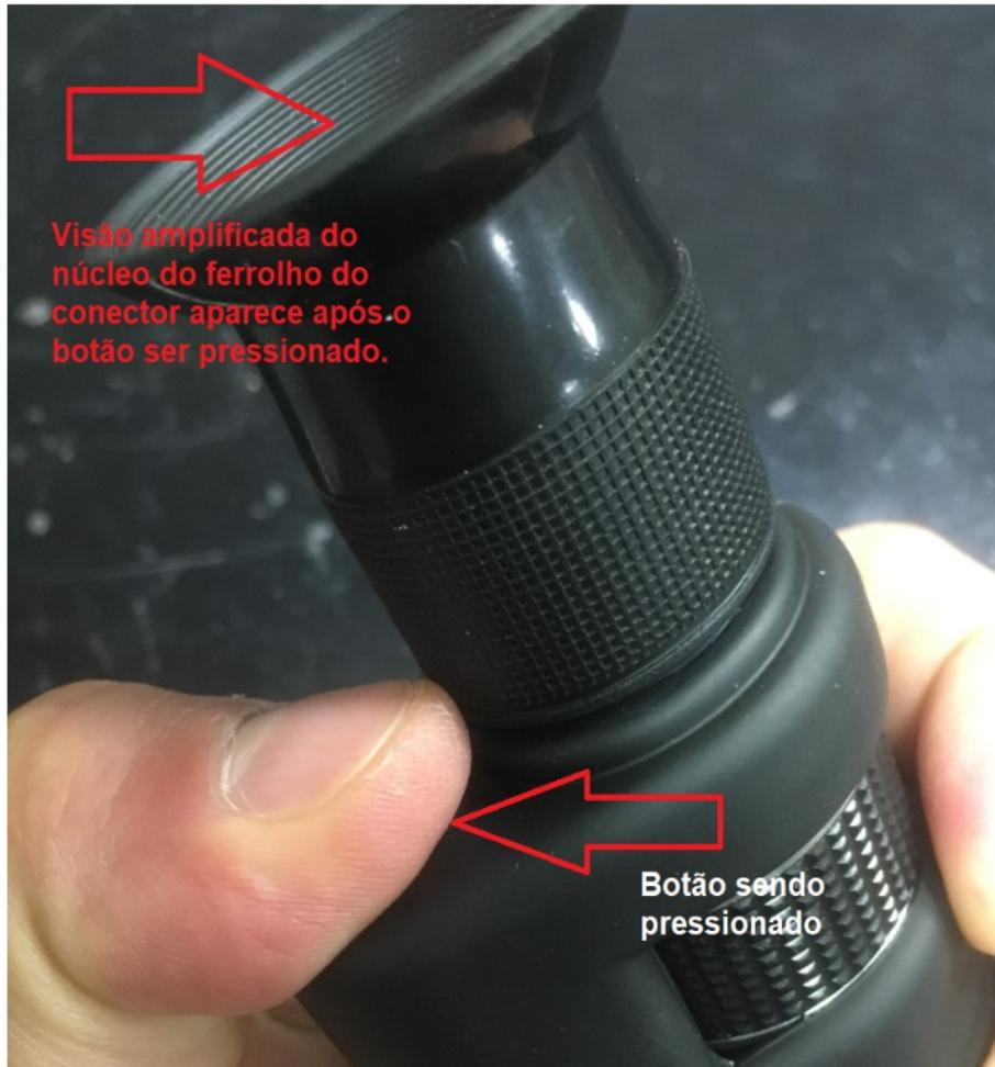
O microscópio possui regulagem de foco, que pode ser movido para a direita e esquerda, até que se encontre o núcleo do ferrolho do conector:
