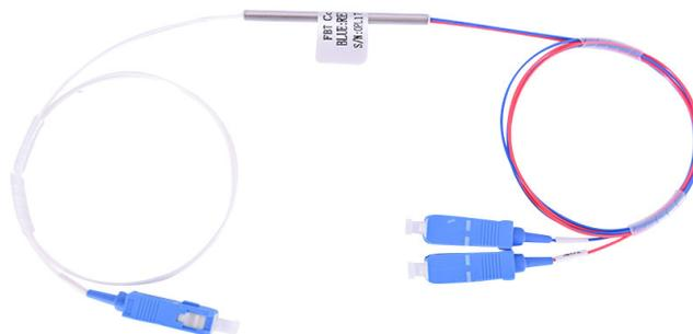
Splitter óptico 1x2 desbalanceado conectorizado no padrão SC/UPC. Tem a função de fazer a divisão do sinal óptico proveniente de uma fibra óptica para duas, em uma proporção de 40% do sinal para uma fibra e 60% para outra.
