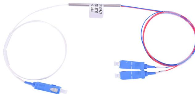
Splitter óptico 1x2 desbalanceado conectorizado no padrão SC/UPC. Tem a função de fazer a divisão do sinal óptico proveniente de uma fibra óptica para duas, em uma proporção de 15% do sinal para uma fibra e 85% para outra.
