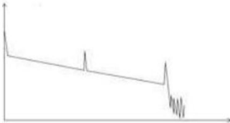
Caso haja picos de reflexões adicionais no rastro testado, os mesmos podem ser causados por pontos de conexões ou algum outro motivo. De qualquer forma, a aparência do pico de reflexão mostra que as duas superfícies estão conectadas suavemente (quanto mais suave a superfície da conexão for, maior o pico de reflexão será).
