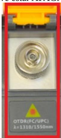
*Porta **OTDR** para medição de fibras **apagadas**.*
