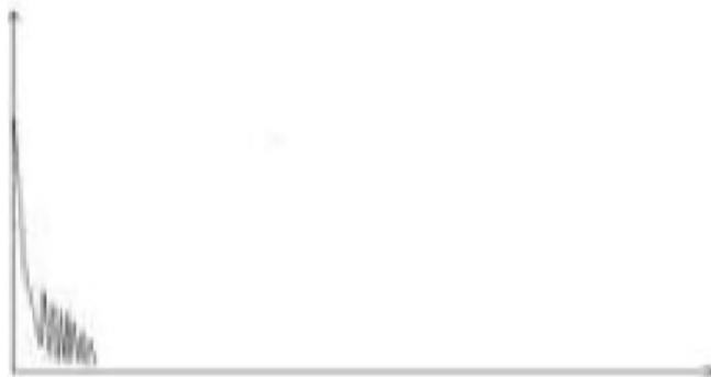
Se o rastro testado estiver como na figura acima, um dos seguintes eventos pode ter ocorrido: má conexão entre os conectores e a porta de lançamento; o pulso óptico não conseguiu ser enviado na porta óptica; há um ponto de rompimento muito próximo na fibra que está sendo testada na conexão inicial; ou, as configurações de distância ajustadas e a largura do pulso é maior do que deveria ser.
