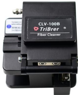
O Clivador de Precisão de Fibra Óptica é um clivador mecânico que realiza o corte preciso da fibra óptica tanto monomodo quanto multimodo de 125µm de diâmetro nominal e revestimento de 250µm e 900µm. O corte é realizado em um ângulo de  $90^\circ \pm 1,0^\circ$ . Ideal para Conectores.
