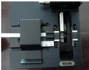
Posicione o cabo drop no carrinho, conforme a figura abaixo:
