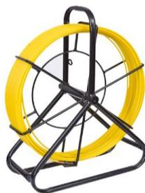
Guia de fibra óptica para dutos 4,5 mm OT- 8509-PF é usado para puxar ou empurrar cabos ópticos através de dutos, tubos, conduítes ou mesmo em galerias subterrâneas com 50 metros de alcance. Ele combina facilidade de operação e desempenho confiável para ajudar a aumentar a eficiência de suas instalações.
